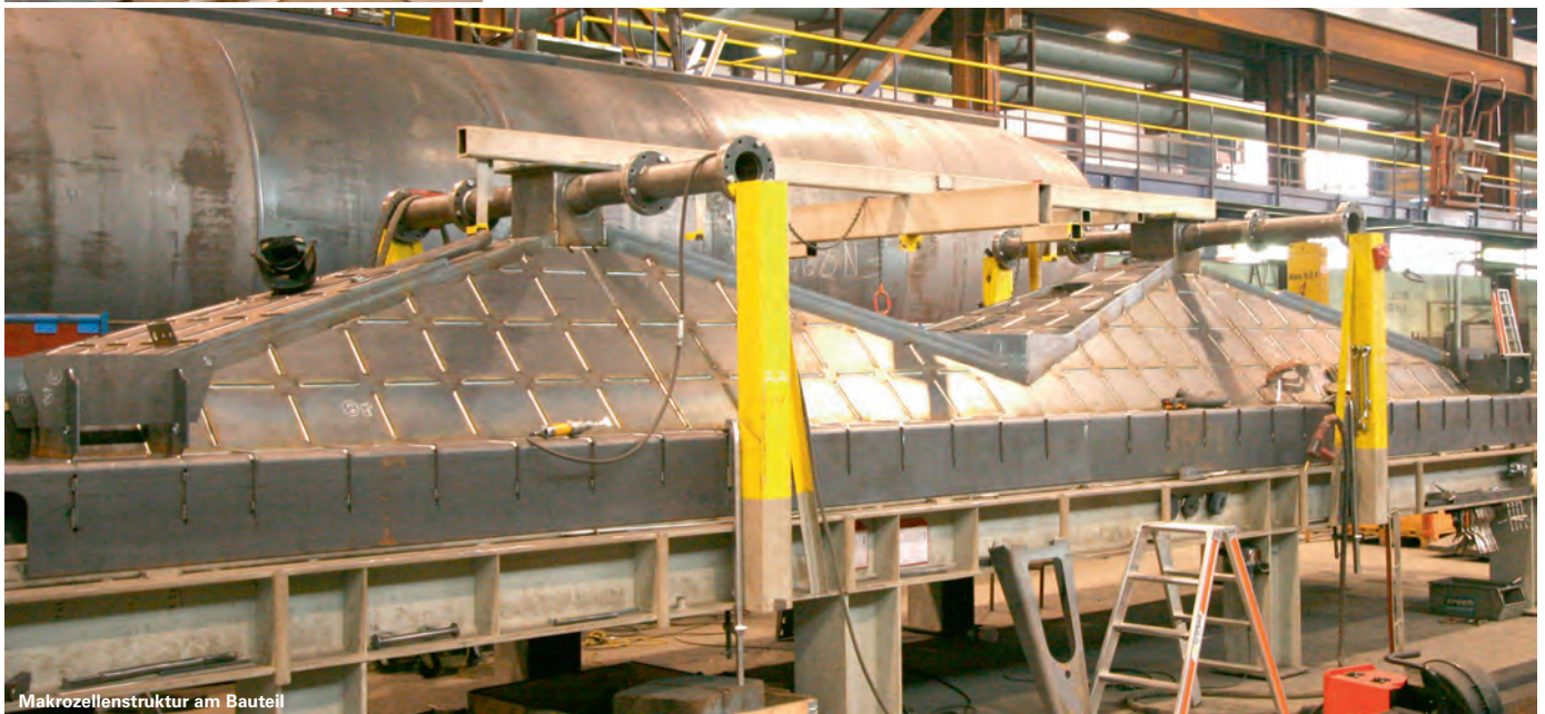
Makrozellenstruktur am Bauteil
